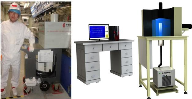
图 1 燃料元件破损在线监测系统
