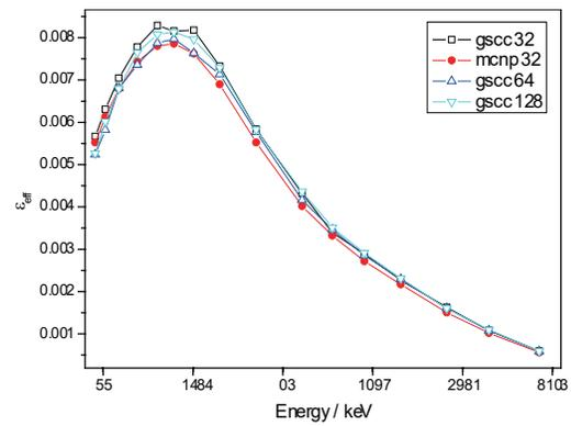
图 4 不同建模精度下颅骨内放射性测量效率刻度因子比较
