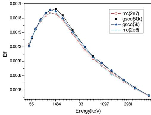
图 2 基于实体肺的肺计数器效率刻度因子计算结果与 MCNP5 程序计算结果的比较
