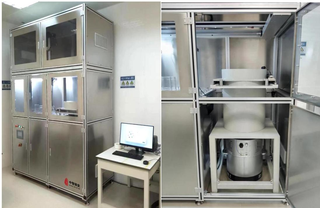
图 1 GammaLIN-L40P 型自动换样高纯锗 $\gamma$ 谱仪
