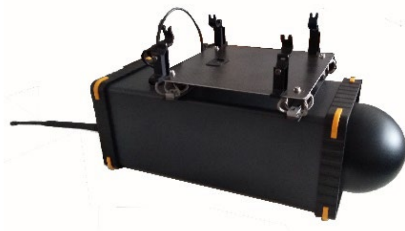
图 1 PeterPan-NaI-GM10 型无人机航测谱仪外观
